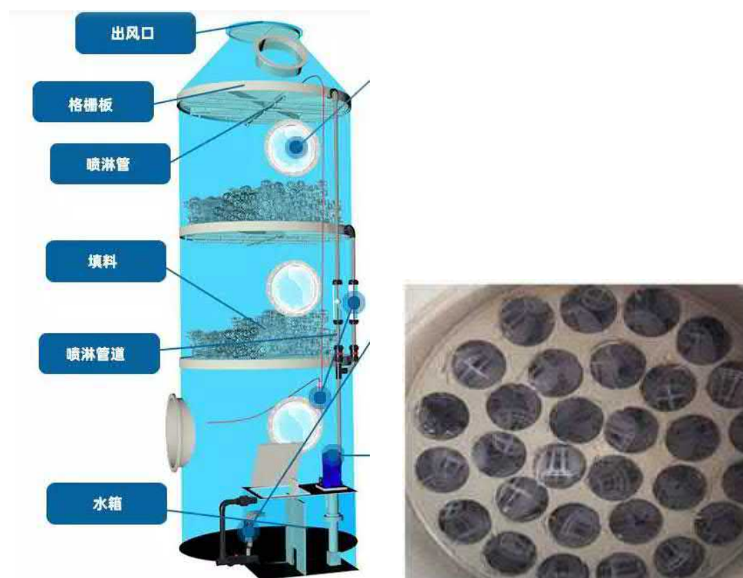
图 9.4-2 喷淋塔装置分布示例图
